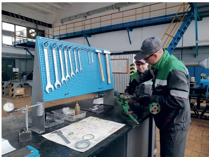
Так, например, спроектированы и изготовлены собственными силами «рабочие верстаки» с рациональной рабочей зоной и набором необходимого инструмента для ремонта оборудования. На начальном этапе коллектив рабочих отнёсся с настороженностью, как и ко всему новому, но без отрицания. Сейчас они сами выдвигают идеи, а мы способствуем их реализации. Мы достигаем результат благодаря постоянству и методичности выполнения намеченного плана», – рассказал начальник производства Ривал Муталов.
